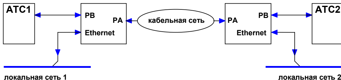
Рис. 23 Пример построения сети на основе мультиплексов ГМ
