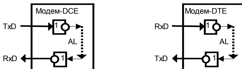
Рис. 45. Включение инверторов для цепей RxD и TxD в тестовых режимах AI, RDL.
