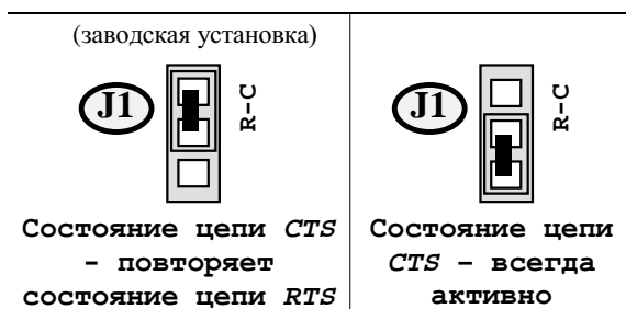
Рис. 8 Положение замыкателя на перемычке J1
