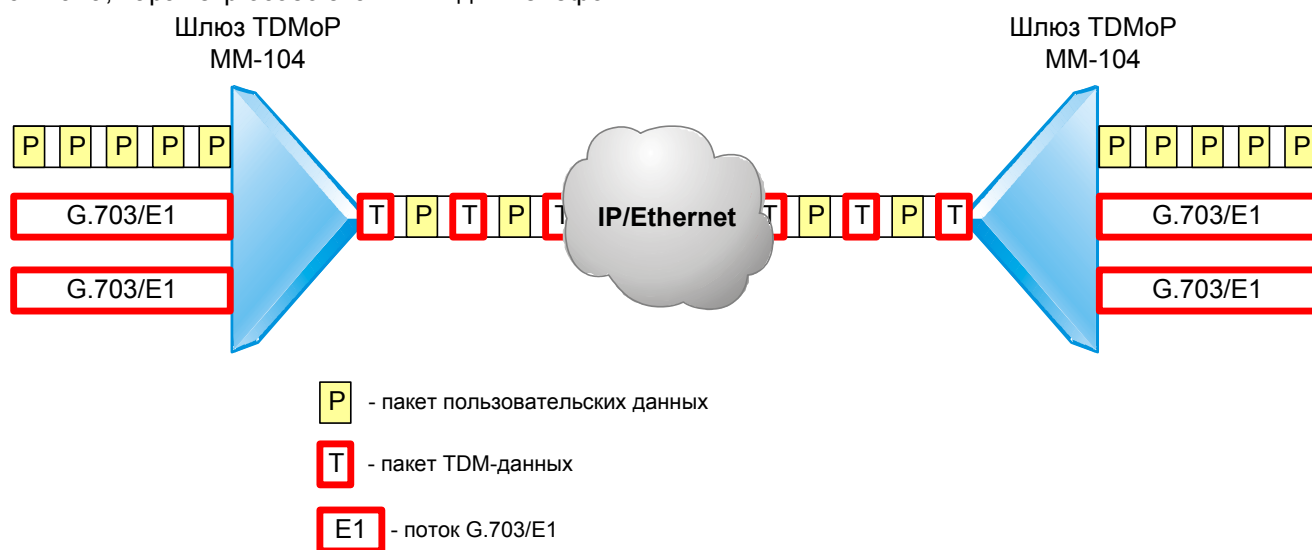
Рис. 1.1. Передача потоков E1 и пользовательских Ethernet-данных через сеть с коммутацией пакетов
