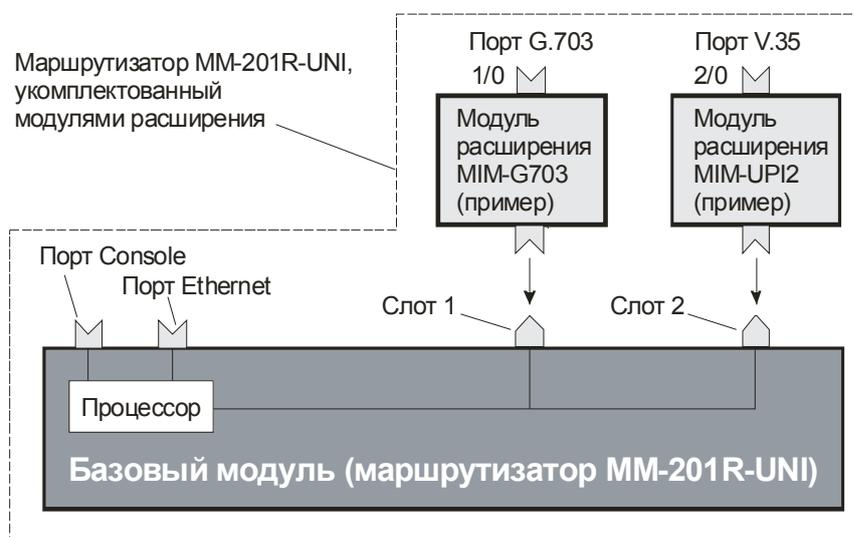
**Рис. 1. Структура маршрутизатора MM-201R-UNI и подключение к нему модулей расширения**
