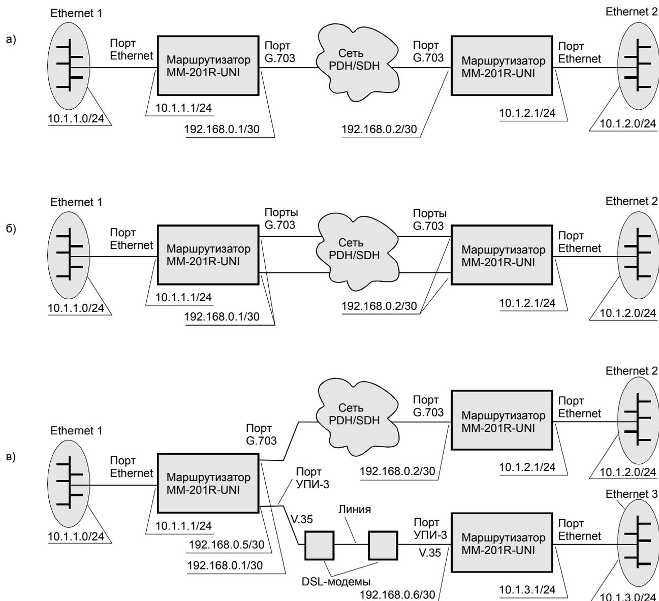
Рис. 3. Примеры построения систем с использованием маршрутизатора MM-201R-UNI
