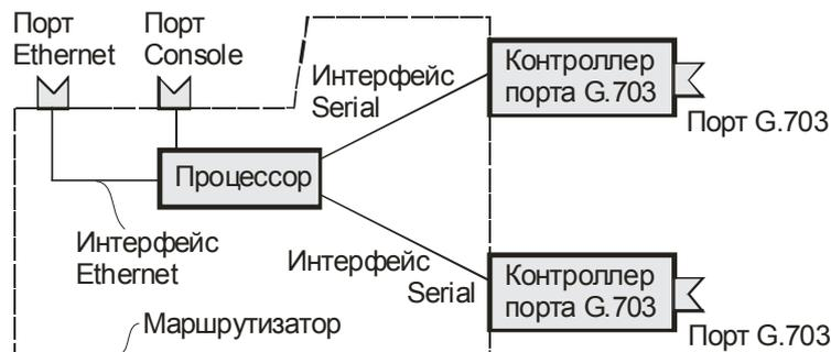
Рис. 2. Внутренние интерфейсы маршрутизатора и контроллеры портов
