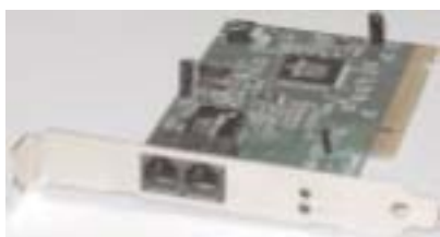
Рис.3. Карточки от D-Link - дальнобойный Ethernet, то есть HPNA по лапше. Фотка у Асмакова.
