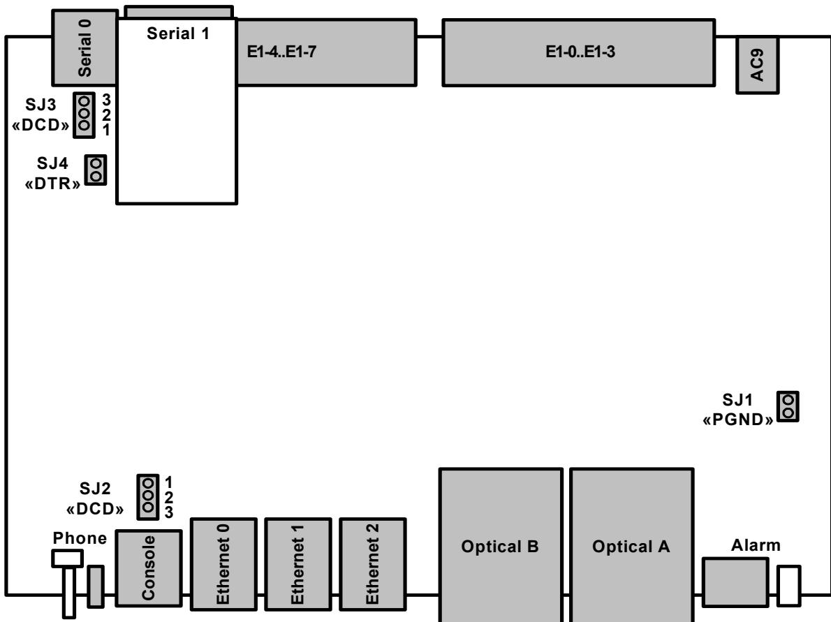
Перемычка **SJ1 «PGND»** предназначена для объединения сигнального и защитного заземления мультиплексора. Заводская установка – перемычка разомкнута.
