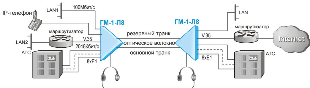
Мультиплексор позволяет объединять удаленные АТС и сегменты высокоскоростной локальной сети, а также подключать независимые локальные сети к Интернет по одной резервированной оптоволоконной линии.
