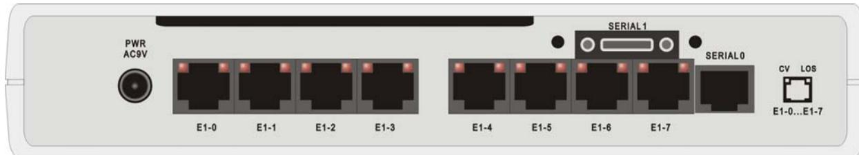
Разъем внешнего питания от внешнего адаптера переменного тока «AC9V» или от источника постоянного тока «=20...72V». Тип разъема определяется модификацией мультиплексора (см. главу 3, стр. 7).
