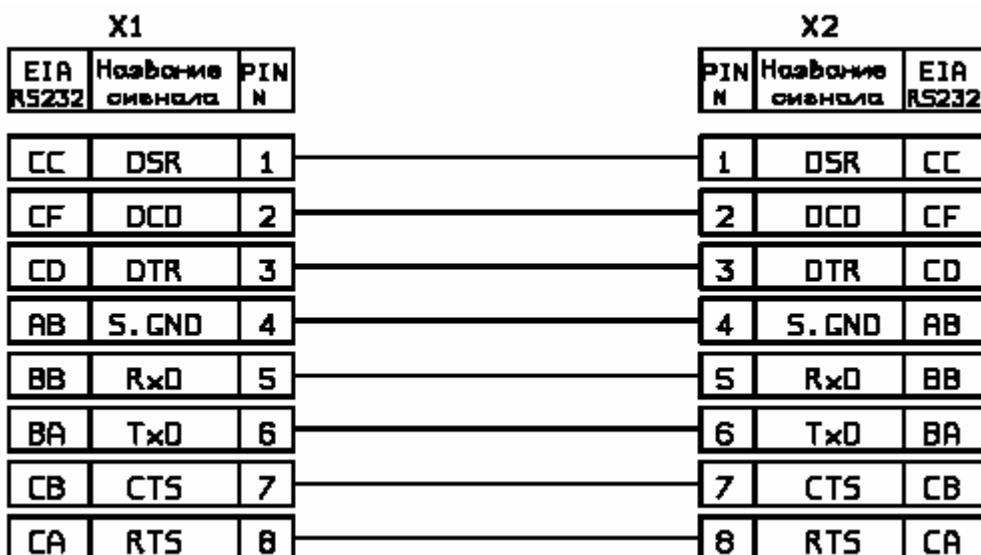
Примечание. X1 и X2 – вилки RJ-45 для плоского кабеля. Используется плоский телефонный кабель 8 жил длиной 2 м.
